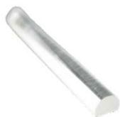
分光器内のCCD素子前にレンズを設置し、縦方向のみを集光することで信号を増加させます。標準の600  $\mu\text{m}$ コアファイバー使用時で約2倍の信号増加が見込めます。
